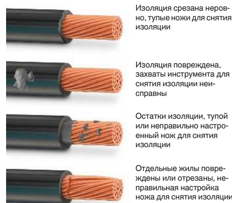
Ошибки снятия изоляции по DIN МЭК 60352
