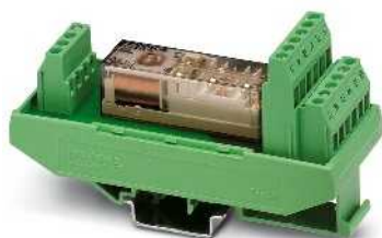
4 замыкающих и 2 размыкающих контакта, для U_N = 24 В перем./пост. тока или 120 В перем./пост. тока
