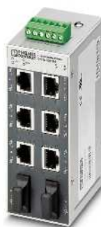
6 портов RJ45 и 2 оптических порта (одномодовые)
