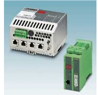
Прокси-устройства служат связующим звеном между сетями PROFINET и другими системами полевых шин
