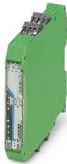
Дополнительный модуль ввода/вывода, 4 дискретных входа
