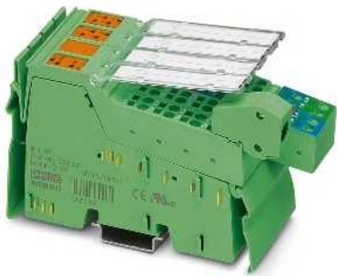
Интерфейс SSI для датчика абсолютного значения
