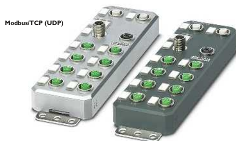
8 дискретных входов и 4 дискретных выхода
