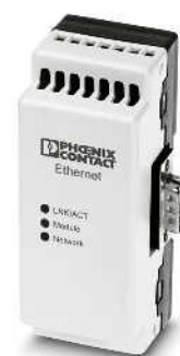
10/100 Мбит/с, сервер Modbus TCP
