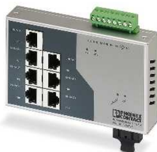
7 / 15 портов RJ45 и 1 оптический порт
