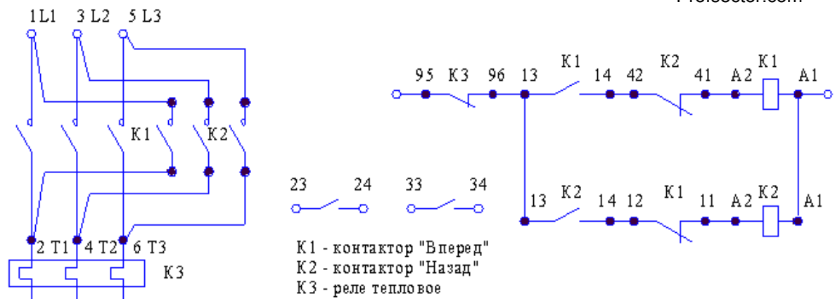
Рис. 10 – Пускатели реверсивные с 4з+2р контактами вспомогательной цепи с блоками контактными БК
