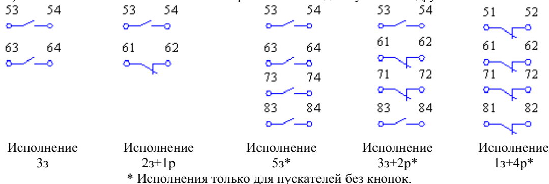
Рис. 2.17 - Пускатели неререверсивные типа ПМ12-025, ПМ12-040 без реле в оболочках степени защиты IP40, IP54
