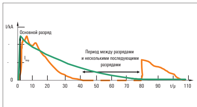
Кривая разряда природной молнии (красный цвет) и смоделированного удара молнии из генератора тока молнии (зеленый цвет)
