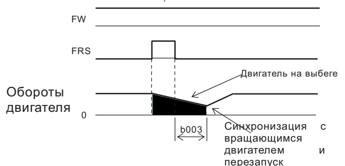
(Пример 2) Синхронизация с вращающимся двигателем и вывод на рабочую частоту по истечении времени, установленного в b003.
