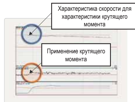
Защита механизма, обеспеченная функцией ограничения крутящего момента
