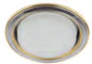
KL35 SN/G сатин никель/золото Ø 105 мм ⌀ 90 мм → 220V ↓ 38 мм ⚡ 13 Вт, GX53
