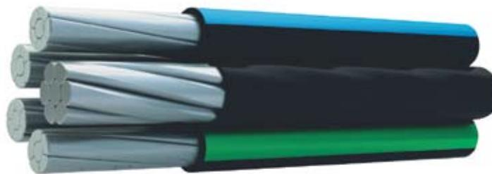
Провод самонесущий с алюминиевыми фазными токопроводящими жилами и несущей жилой из сплава алюминия, все жилы изолированы светостабилизированным сшитым полиэтиленом (ПЭ).
