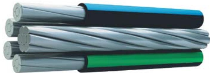
Провод самонесущий с алюминиевыми фазными токопроводящими жилами, с изоляцией из светостабилизированного сшитого полиэтилена (ПЭ), с неизолированной несущей жилой из сплава алюминия.
