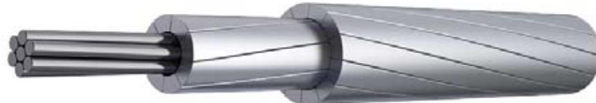
Неизолированные провода СЕНИЛЕК изготовлены из стальной оцинкованной проволоки и проволоки из термостойкого алюминиевого сплава с рабочей температурой до 210 °С. Стальная проволока и проволока из алюминиевого сплава имеют повышенные механические характеристики.
