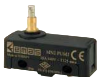
Плунжер подпружиненный Spring Plunger
