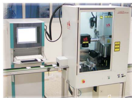
12) В конце концов на изделия наносится лазерная печать. Лазер может выжигать рисунок от верхней части (боковая поверхность изделия) до боковой части(передняя панель и клеммы). Печать на одном изделии продолжается около 30 с.
