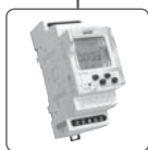
TER-9 2 темпер. входа, 2 выхода 8А переключ., 6 функций, встроенный коммут. таймер, LCD с подсветкой, гальванич. изолированное питание AC 230V, 2 - МОДУЛЬ. Температурный диапазон: -40 °C... +110 °C.
