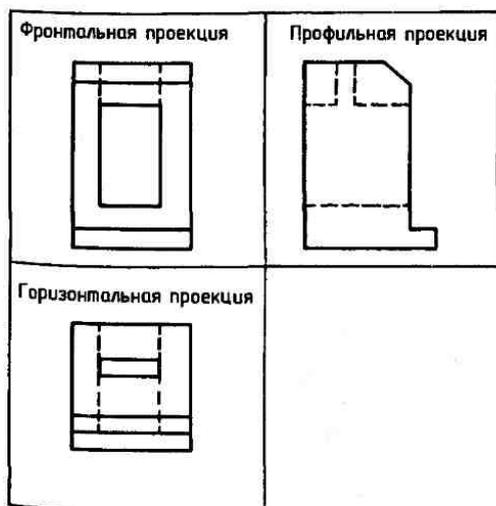
Рис. 2.19. Комплексный чертеж
