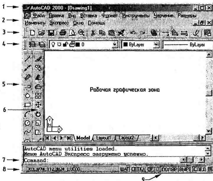
Рис. 10.6. Рабочее окно AutoCAD
