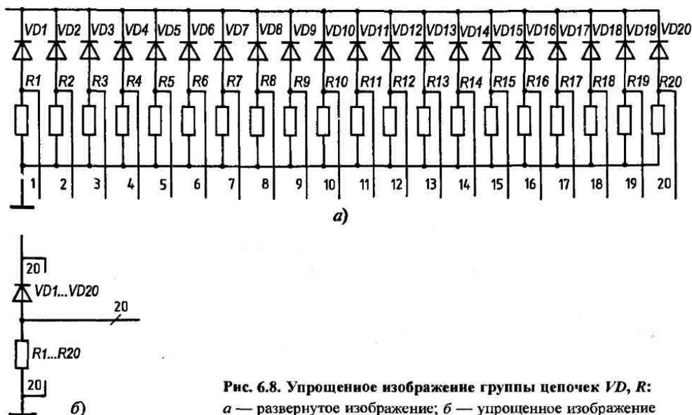
Рис. 6.8. Упрощенное изображение группы цепочек  $VD, R$ : а — развернутое изображение; б — упрощенное изображение
