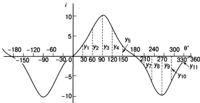
**Табл. 14.2** и включает пять гармоник, откуда можно определить коэффициенты Фурье  $b_1$ ,  $b_3$  и  $b_5$ . Выбраны 12 координат, обозначенные  $y_1, y_2, y_3, \dots, y_{12}$ , как показано на **Рис. 14.15**.
