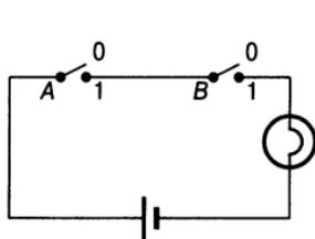
а) Переключательная схема функции И
