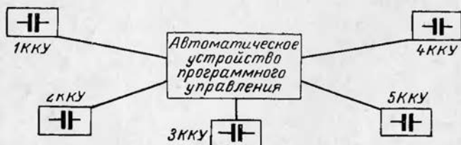
Рис. 26. Схема программного управления несколькими конденсаторными установками от общего автоматического устройства.
