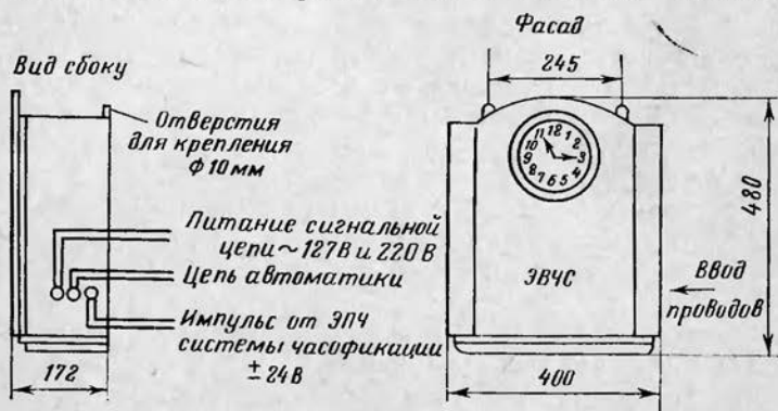
Рис. 18. Конструкция электровторичных сигнальных часов типа ЭВЧС-24.
