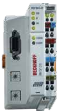
Bus Coupler серии BK, связь между промышленной шиной и модулями ввода-вывода
