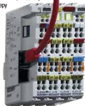
Модули расширения позволяют подключить до 255 модулей ввода-вывода (вместо 64) к одному контроллеру/коптеру
