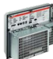
C6525 со слотами для дополнительных карт
