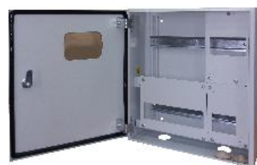
ЩУНС-1х4+1х12-СЭ1-IP54-У1-013 (Коттеджный) Навесной, с цельнометаллической дверкой, с окошком под электронный счётчик, до 16 модулей
