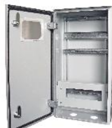
ЩУНС-1х9-2-СЭ3-IP54-У1-011 (Коттеджный) Навесной, с козырьком, с цельнометаллической дверкой, с окошком под электронный счётчик, до 9 модулей
