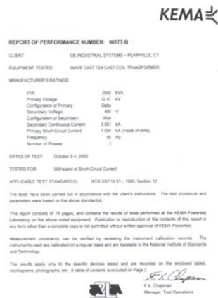
Отчет об испытаниях на короткое замыкание силового трансформатора мощностью 2,5 МВА и с напряжением 12,47 кВ в лаборатории KEMA USA
