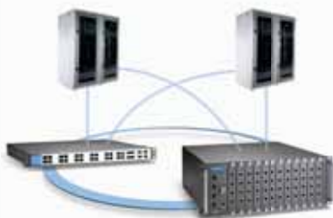
Кольцевые топологии и Uplink-соединения 10 Gigabit Ethernet
