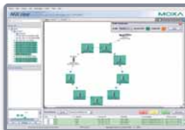
Отображение подсетей VLAN по цветовым группам и отслеживание сетевого трафика IGMP
