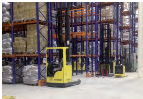
Высота склада 12 м, стеллажей 9 м, ширина проезда 3,5 м Погрузочно-разгрузочная зона светильник ДСП15 -160-101 Kosmos, Еккс>200лк Стеллажи ДСП15-160-201 Kosmos, Ев=100 лк (h=2 м), Ев=200 лк (h=7 м)
