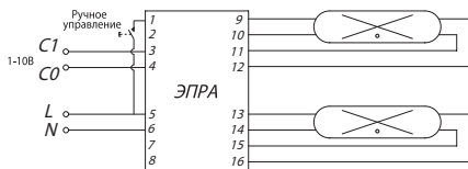
Схема включения двухламповая с ЭПРА, с управлением
