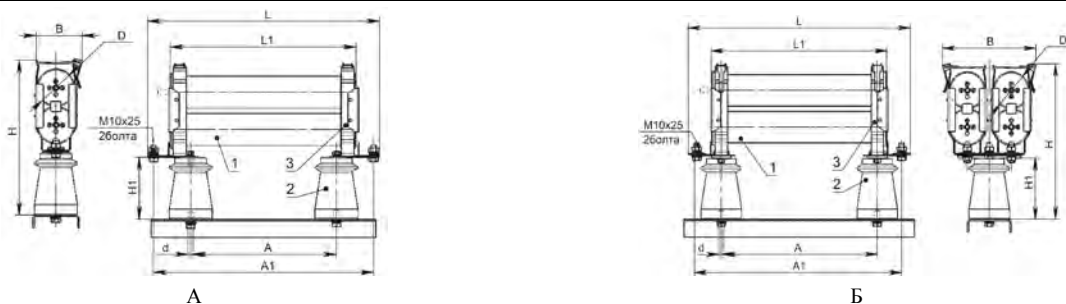
Рисунок 2. Габаритные и установочные размеры предохранителей ПКТ-103, ПКТ-104.
