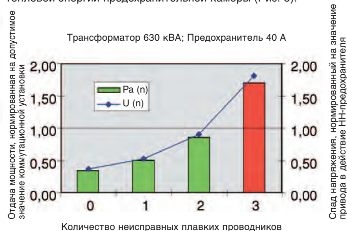
Рис. 5: Контроль отдачи мощности при 1,3-кратном расчетном токе трансформатора
