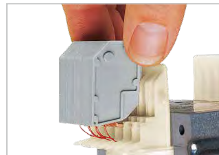
После присоединения проводников катушек (IDC: только один проводник на контакт, допускается петля), соедините клеммы и торцевую пластину в один модуль перед установкой на катушку трансформатора.
