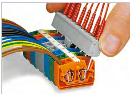
Испытание при помощи сборки тестового штекера – точечный контакт.
