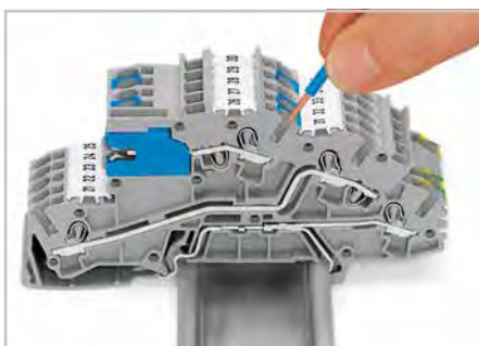
Подключение однопроводных проводников простой вставкой в зажим.
