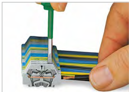
Вставка проводника при помощи рабочего инструмента.
