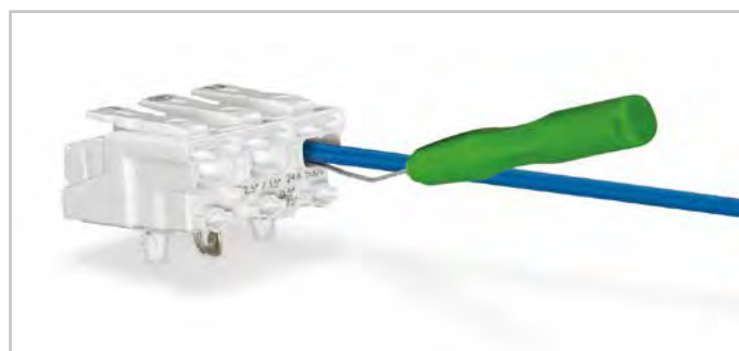
Извлечение проводника: вставьте инструмент для демонтажа в отверстие клеммы под проводник и извлеките проводник из клеммы.
