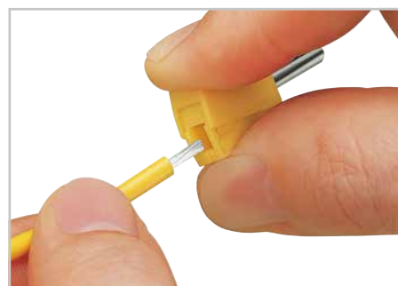
Подключение проводника: полностью нажмите кнопку и вставьте зачищенный проводник в квадратное отверстие, отпустите кнопку.
