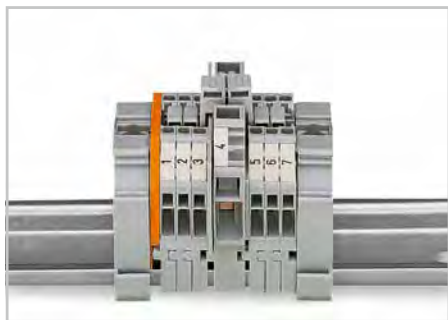
Объединение монтируемых на рейку клемм от 6 мм 2 (серия 282) до 1,5 мм 2 (серия 279) с использованием ступенчатых перемычек.
