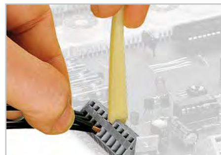
Вставка проводника при помощи специального инструмента.
