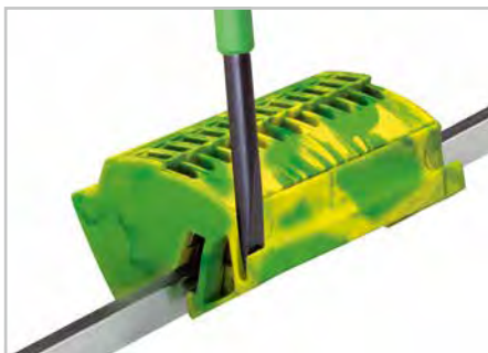
Разблокируйте правый и левый фиксаторы для снятия клеммы с заземлением. Затем снимите клемму со сборной шины.
