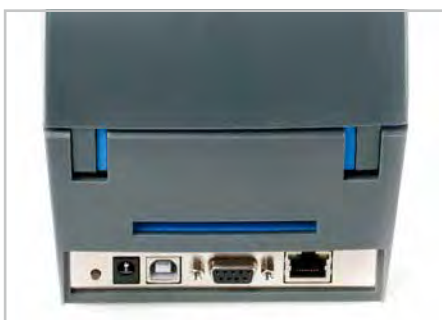
Принтер имеет несколько разъемов: USB, ETHERNET, последовательный COM-порт
