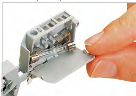
При открывании крышки держателя происходит автоматическое высвобождение предохранителя из держателя.
