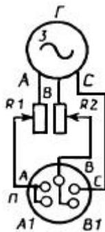
Г - генератор трехфазного напряжения; R1, R2 - переменные резисторы;
