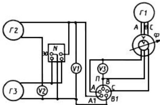
А, В, С, А1, В1 - зажимы синхроноскопа; Г1 - трехфазный генератор; Г2, Г3 - однофазные генераторы; V1, V2, V3 - вольтметры среднего квадратического значения класса I; Ф - фазорегулятор; Π - проверяемый синхроноскоп; ЭО - осциллограф электронный лучевой
