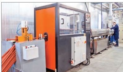
Линии для экструдирования термоусаживаемой трубки
