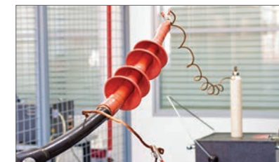
Высоковольтные испытания кабельных муфт
