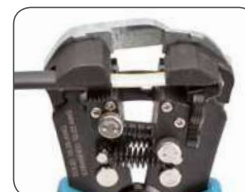
Снятие оболочки многожильного провода
