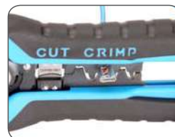
Опрессовка автоклема под двойной обжим
