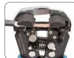
Одновременное снятие изоляции с трех проводов
