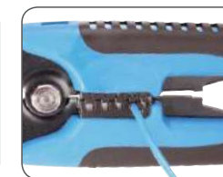
Опрессовка наконечника HSHV
