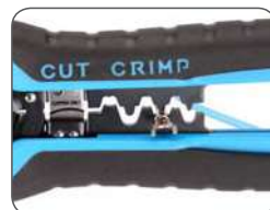
Опрессовка неизолированного наконечника
