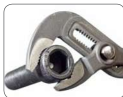
Захват круглых деталей
