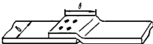
Рис.67. Изгиб "уткой" для соединения шин внахлестку
