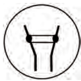
МЭК 60947-5-1 Механически связанные контакты
