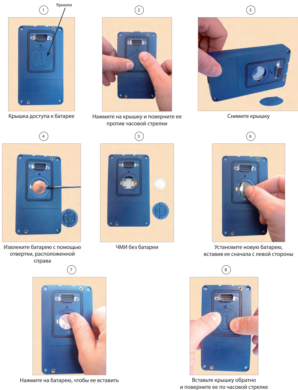
Рис. 4.2. Замена батареи ЧМИ
