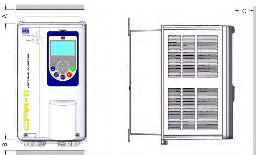
Рис. 3.2 - Минимальные требования к верхнему, нижнему и переднему зазорам, необходимым для циркуляции воздуха
