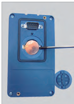
Извлеките батарею с помощью отвертки, расположенной справа
