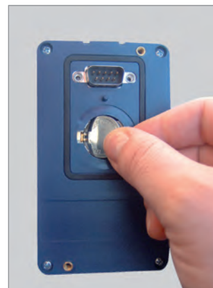
Установите новую батарею, вставив ее сначала с левой стороны
