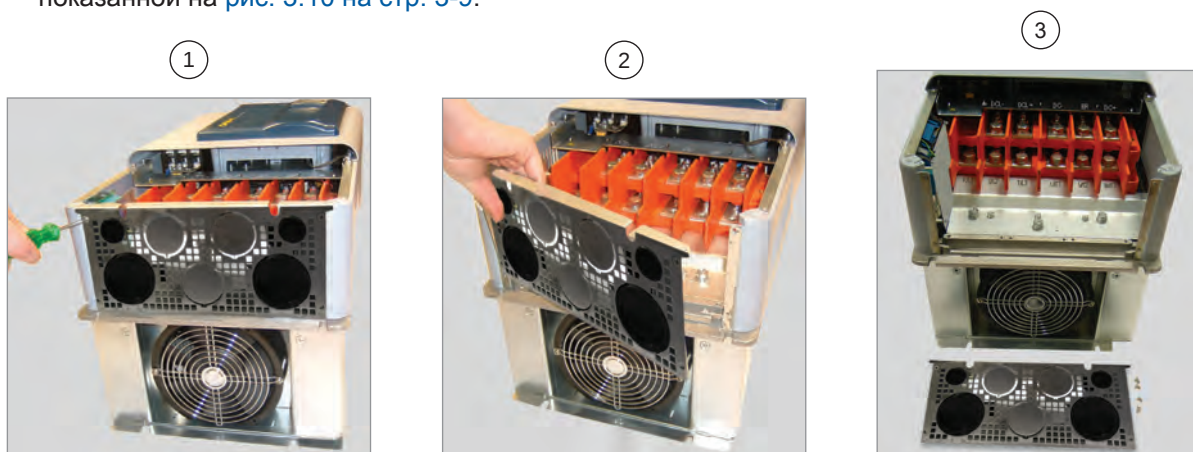
Рис. 3.11 - Снятие панели кабельной проходки
