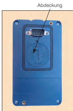
Abb. 31: Batteriefachabdeckung des Bediengeräts
