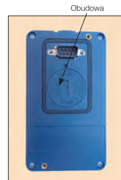
Rysunek 28: Pokrywa baterii panelu z przyciskami i dostęp do baterii
