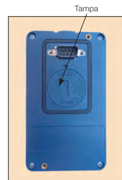
Figura 31: Localização da tampa de acesso à bateria
