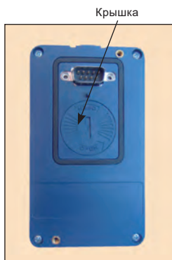
Рис. 31.: Крышка аккумуляторной батареи клавиатуры для доступа к батарее
