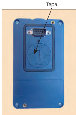
Figura 31: Localización de la tapa de acceso a la batería
