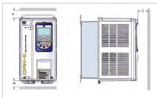
Рис. 1.: Габаритные размеры для монтажа
