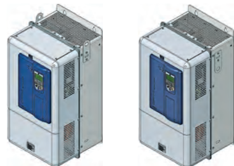
Figura 4: Instalación de las chapas para izamiento del convertidor de los tamaños E, F, G y H
