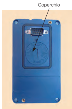
Figura 31: Coperchio batteria tastiera per accesso alla batteria
