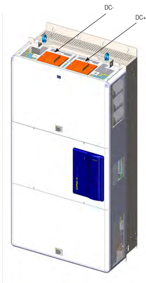
(d) Размер корпуса G со специальным оборудованием постоянного тока: Клеммы для подачи постоянного напряжения. В этой версии клеммы R/L1, S/L2 и T/L3 не подключены внутренним образом
