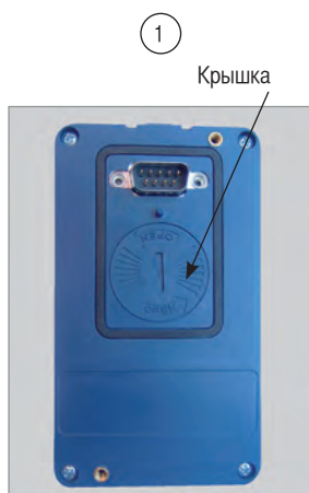
Расположение крышки доступа к батарее
