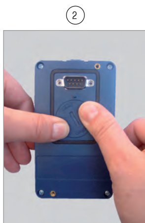
Надавите крышку и поверните ее против часовой стрелки
