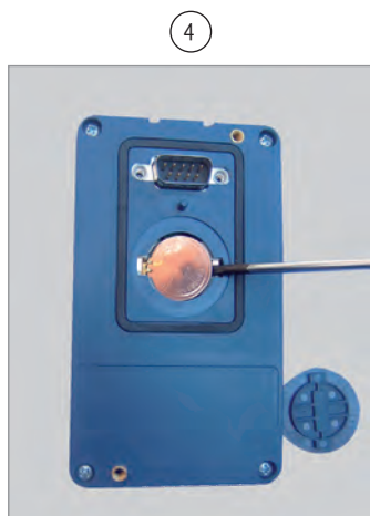
Извлеките батарею с помощью отвертки, расположенной справа
