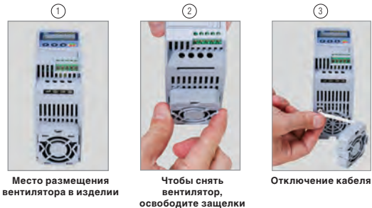
Рисунок 6.1: Снятие вентиляторов радиатора
