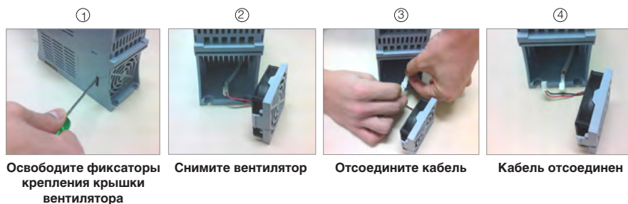
Рис. 6.1. Снятие вентилятора радиатора охлаждения
