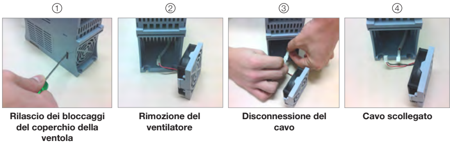
Figura 6.1: Rimozione della ventola del dissipatore
