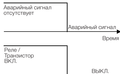
Рисунок 13.6. (a)–(r) Подробное описание работы функций цифровых и релейных выходов
