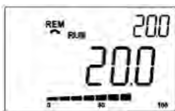
Рисунок 19.21. Пример ЧМИ в режиме мониторинга для использования функции контроллера ПИД2
