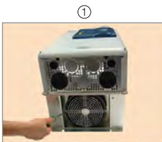
Entfernung der Lüftungsgitterschrauben
