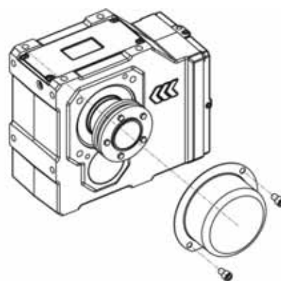
Рис. 10: Защитный кожух стяжной муфты полого вала
