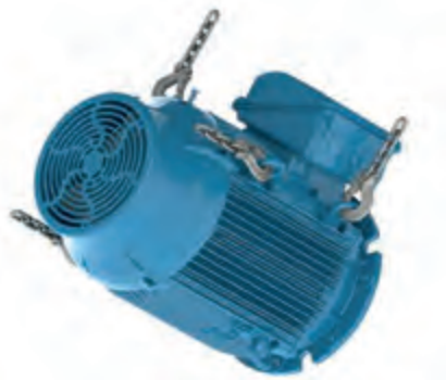
Фигура 4.19 - Двигателят се завърта в хоризонтално положение
