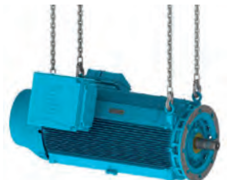
Figura 4.13 - Içamento dos motores HGF e W50 utilizando duas talhas
