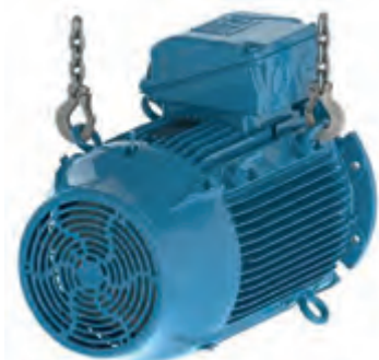
Figurii 4.20 - Rezultatul final: motorul se află în poziție orizontală
