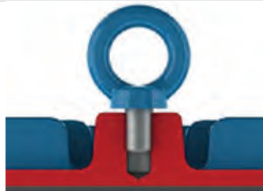
Фигура 4-2 – Неправилно затягане на болта с халка
