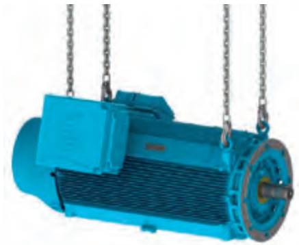
Figura 4.13 - Elevación del motor HGF y W50 utilizando dos grúas
