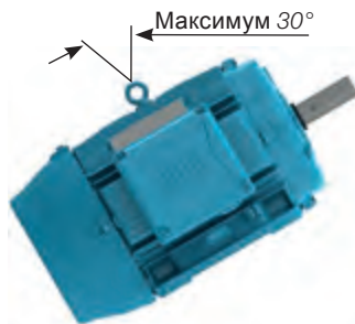
Рисунок 4.3 - Максимально разрешенный угол отклонения для двигателей с одним рым-болтом
