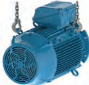
Фигура 4-10 – Изваждане на двигателя от опаковката
