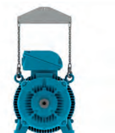
Figura 4.7 - Uso de barra separadora no içamento
