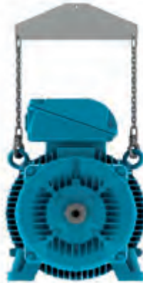
Bild 4.7 - Einsatz eines Querbalkens zum Heben
