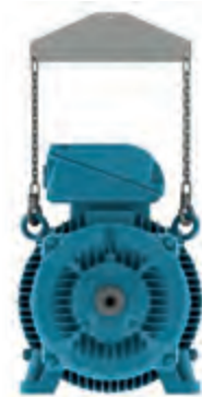
Figurii 4.7 - Utilizarea unei bare distanțier pentru ridicare
