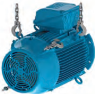
Figura 4.11 - Instalación del segundo par de cáncamos
