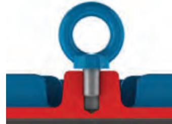
Рисунок 4.2 - Неправильное затягивание рым-болта
