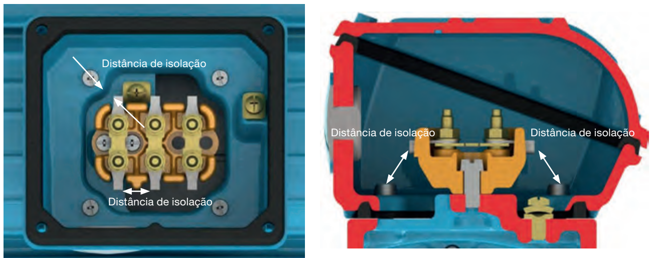
Figura 6.15 - Representação da distância de isolamento.
