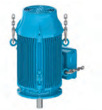
Figura 4.12 - Resultado final: motor posicionado na vertical
