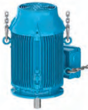
Рисунок 4.12 - Конечный результат: электродвигатель расположен вертикально
