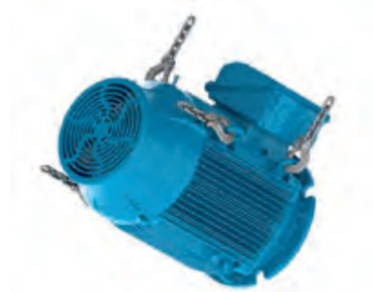
Bild 4.19 - Der Motor wird in die horizontale Lage gewendet
