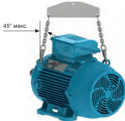
Фигура 4-4 – Максимален ъгъл за двигатели с два или повече болта с халки
