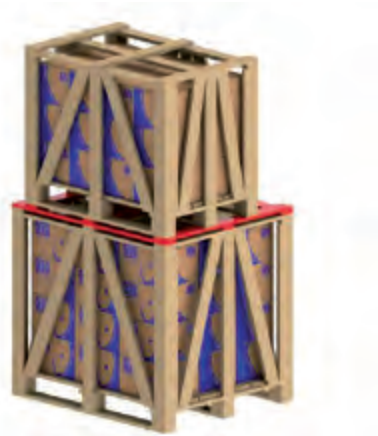
Figura 5.5 - Utilización de varas adicionales para apilamiento
