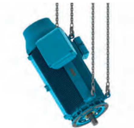
Bild 4.14 - Motoren der Baureihe HGF und W50 in die vertikale Lage aufstellen
