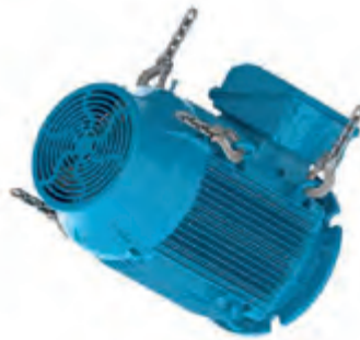
Рисунок 4.19 - Вращение двигателя в горизонтальное положение
