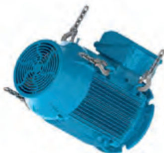
Figura 4.19 - Motor está sendo girado para a posição horizontal
