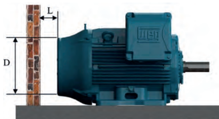
Figura 7.1 - Distancia mínima del motor hasta la pared
