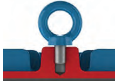
Figurii 4.2 - Strângerea incorectă a unui șurub cu ochi
