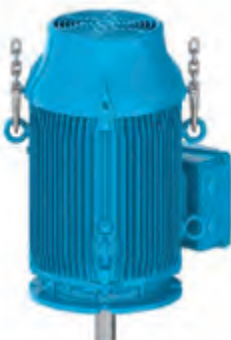
Figura 4.17 - Instalação do primeiro par de olhais
