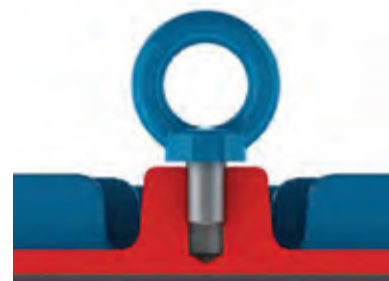
Bild 4.2 - Falsche Befestigung der Transportösen
