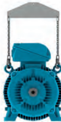
Figura 4.7 - Uso de barra separadora en la elevación
