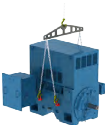
Figura 4.6 - Ridicarea motoarelor W60 cu lanțuri paralele
