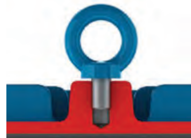
Figura 4.2 - Manera incorrecta de fijación del cáncamo de elevación
