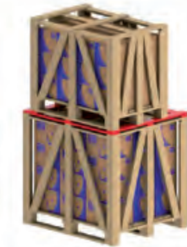
Bild 5.5 - Einsatz von zusätzlichen Leisten zum Stapeln von Lattenkisten
