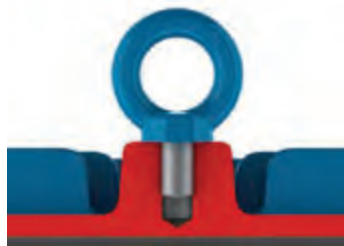
Рисунок 4.1 - Правильное затягивание рым-болта
