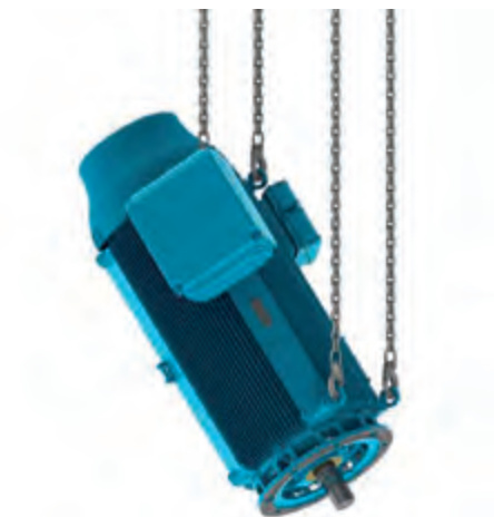
Figura 4.14 - Colocação dos motores HGF e W50 na vertical
