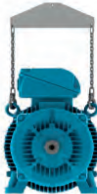
Рисунок 4.7 - Использование распорной траверсы при подъеме
