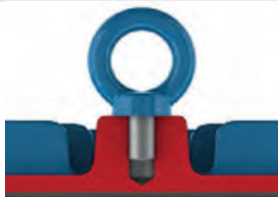
Фигура 4-1 – Правилно затягане на болта с халка
