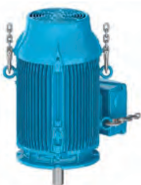
Figurii 4.12 - Rezultatul final: motorul se află în poziție verticală
