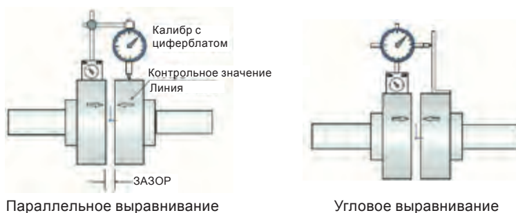
Рисунок 6.11 - Выравнивание с помощью калибра с циферблатом
