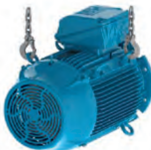
Figura 4.20 - Resultado final: motor posicionado de forma horizontal
