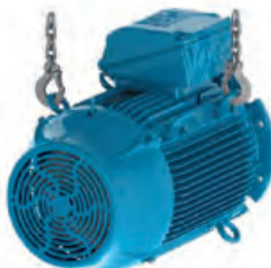
Рисунок 4.20 - Конечный результат: электродвигатель расположен горизонтально
