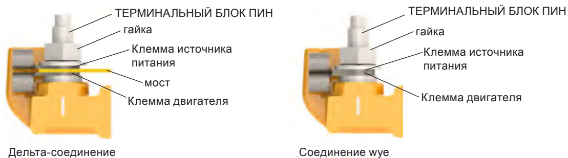
Рисунок 6.13 - Подключение для двигателей W21 и W22 с клеммной колодкой
