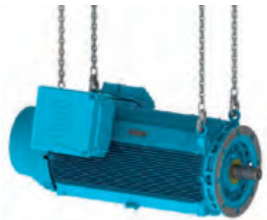
Рисунок 4.13 - Подъем электродвигателей серий HGF и W50 с использованием двух подъемных строп.
