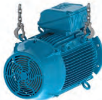
Figura 4.10 - Remoção do motor da embalagem
