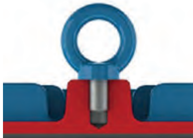
Figurii 4.1 - Strângerea corectă a unui șurub cu ochi
