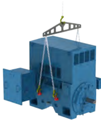
Рисунок 4.6 - Подъем для двигателей W60 с параллельными цепями.
