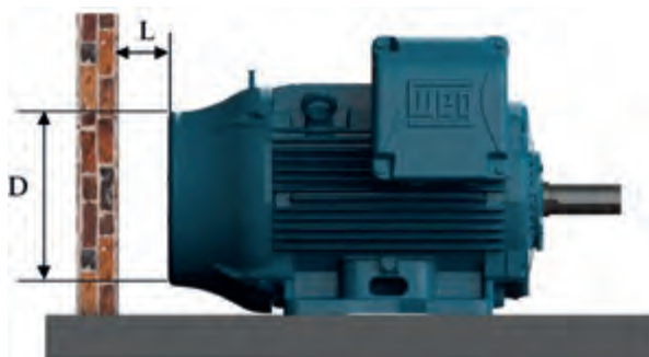
Рисунок 7.1- Минимальное расстояние до стены
