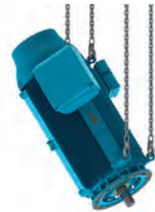
Figura 4.14 - Colocación de motor HGF y W50 en posición vertical
