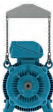
Фигура 4-7 – използване на раздалечителен елемент
