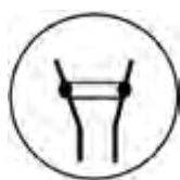
IEC 60947-5-1 Механически связанные контакты
