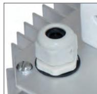
Герметичный кабельный ввод PG13,5 IP65 для кабеля диаметром от 6 до 12 мм
