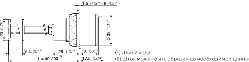
KPR3, KPR4 Габаритные размеры (мм, дюймы)
