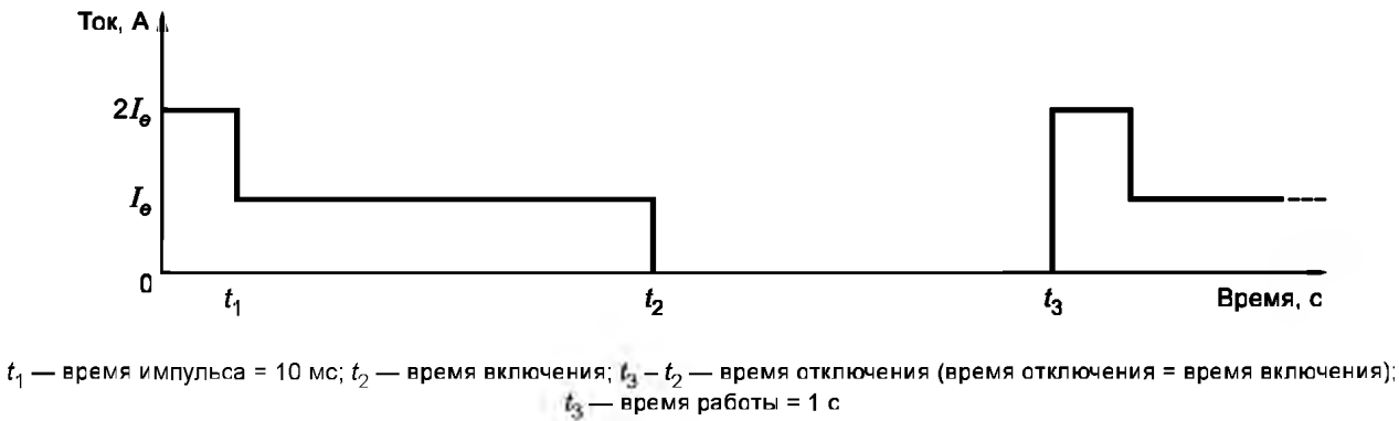
Рисунок S.4 — Временные интервалы коммутационного переключения для цифровых выходов постоянного тока
