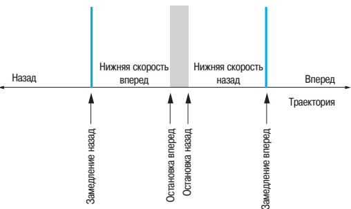
Пример 2: позиционирование в заданном месте Контакт может быть использован для перемещения за место остановки при повторном пуске
