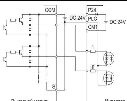
После включения программируемого логического контроллера и его внешнего источника питания обязательно включите частотные преобразователи, чтобы их внутренние параметры не подверглись изменениям.
