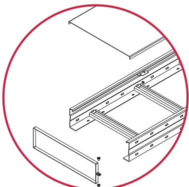
! Хомут ХКЛКР предназначен для фиксации крышки лотков серии ЛКР. Обеспечивает надежное крепление крышки при максимальных ветровых нагрузках. Хомут выполнен из металла. В стандартную комплектацию входит винт M6x10 и гайка M6 с буртиком. Хомут устанавливается на собранную кабеленесущую трассу в свободных от монтажа и соединения местах. Рекомендуем использовать три хомута на пролете 6 метров. На лотках шириной 500 и 600 мм рекомендуем использовать четыре хомута.
