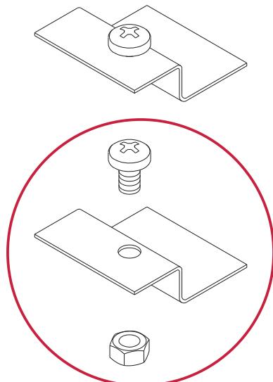
! Фиксатор ФКЛКР предназначен для фиксации крышек к лотку и углам серии ЛКР.
