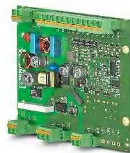
Зарядный контроллер перем. тока Basic, печатная плата, процесс зарядки С, с разъемом MSTB
