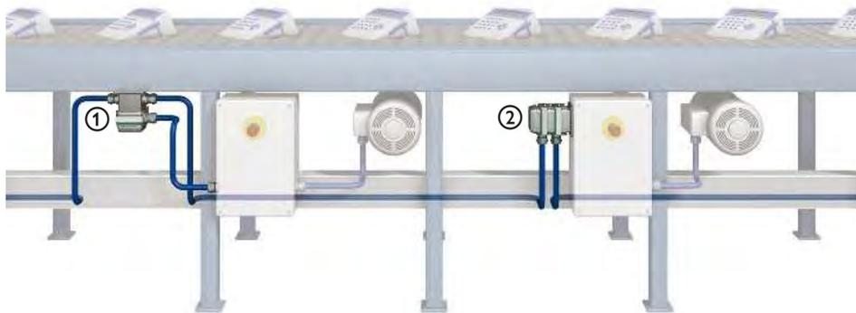
Для стационарных систем распределения энергии компоненты DUPLICON открывают два основных способа подключения:
