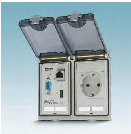
Розетка предусматривает возможность использования независимо от токового контура электрошкафа. В случае возникновения сбоя это позволяет использовать внешнее измерительное устройство с питанием от электросети для анализа ошибок. Светодиодный индикатор сигнализирует о доступном напряжении на розетке.
