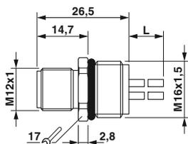
Размеры: штекер, монтаж на передней панели
