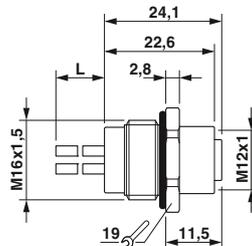
Размеры: гнездо, монтаж на передней панели
