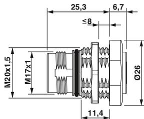
Монтаж на заднюю стенку, M20 x 1,5, Контргайки заказываются отдельно
