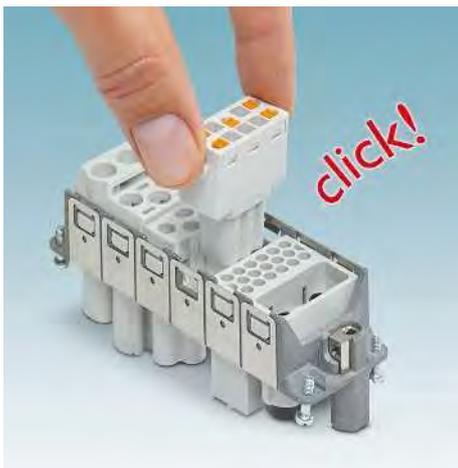
HEAVYCON modular позволяет сэкономить время и средства за счет объединения нескольких штекерных соединителей в один. Модульные вставки подходят к корпусам типоразмеров HC-B (HC-EVO, HC-STA, HC-ADV, ...). Штыревые и гнездовые модули можно произвольно комбинировать и защищать от неправильного подключения.
