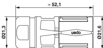
**Кабельные соединители, стандартный фиксатор M17**
