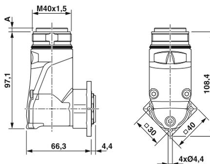
Исполнение штифтов: размер A = 3,7 мм, исполнение гнезда: размер A = 0,05 мм
