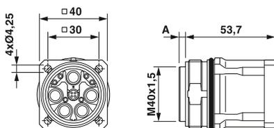
Исполнение штифтов: размер A = 3,8 мм, исполнение гнезда: размер A = 0,15 мм
