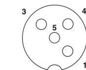
Расположение контактов гнездового разъема M12, 4 контакта
