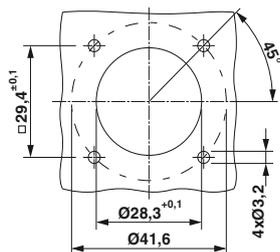
Установочные размеры короткой и длинной конструкции
