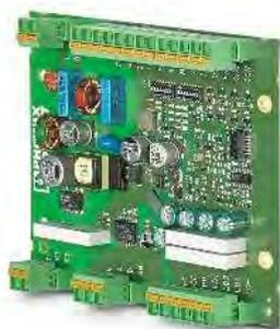
Зарядный контроллер перем. тока Basic, печатная плата, процесс зарядки В, с разъемом MSTB
