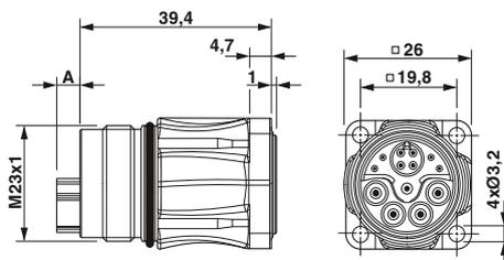
Исполнение штифтов: размер A = 4,75 мм, исполнение гнезда: размер A = 0 мм
