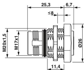
Монтаж на заднюю стенку, M20 x 1,5,
