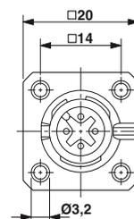
Приборный соединитель для датчиков/исполнительных элементов M12, монтаж на переднюю стенку
