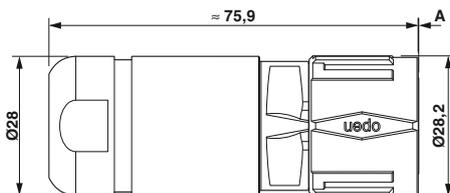
Исполнение штифтов: размер A = 0,2 мм, исполнение гнезда: размер A = 0 мм
