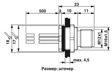
Приборный соединитель для датчиков/исполнительных устройств M12, монтаж на заднюю стенку
