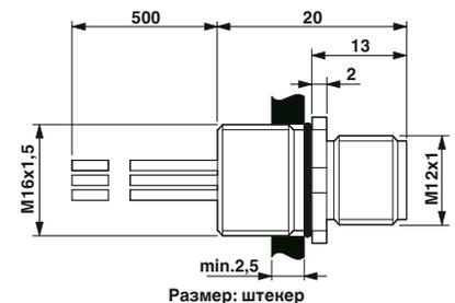
Приборный соединитель для датчиков/исполнительных элементов M12, монтаж на переднюю стенку
