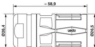
**Кабельные соединители, стандартный фиксатор M23**
