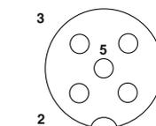
Расположение контактов гнезда M12, 5-контактное
